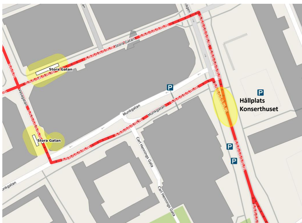
Figur 6: Förslag till hållplatsläge
